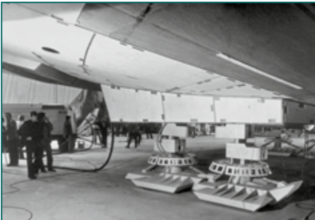
Полномасштабная модель «Сокола» на завершающей стадии. Корпус обшит листами фанеры, а второй слой вырезанных листов с вырубленными краями имитирует броню
